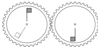
As engrenagens são iguais e quando a engrenagem da esquerda girou um pouco, a sua bandeirinha ficou na posição indicada com a bandeirinha branca pontilhada. Nesta condição, podemos afirmar que a posição da bandeirinha na engrenagem da direita é:
