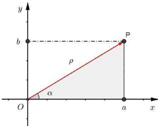
Um plano munido desse sistema de coordenadas ortogonais é chamado de **Plano de Argand-Gauss** e o ponto  $P$  cujas coordenadas são  $(a, b)$  é chamado de **Afixo de  $z$** . Na figura acima, o comprimento do vetor  $\overrightarrow{OP}$  é representado por  $\rho$  (ou  $|z|$ ) é chamado de **módulo** do números complexo  $z$ . Pelo Teorema de Pitágoras, segue que
